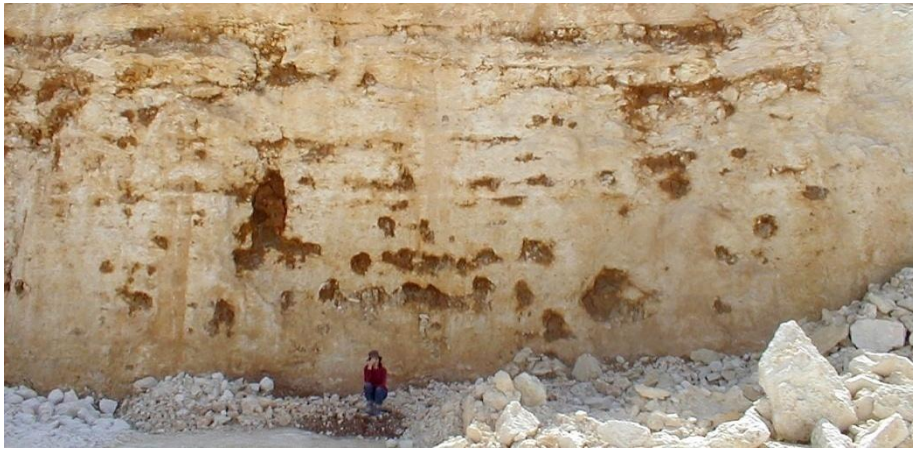
1/ Vides remplis d'altérites présumées (grises) et d'argile de décalcification (brune).
