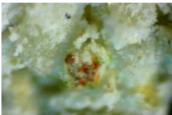
Microscopie. Calcaire du Creux Nègre : hématite (oxyde de fer).
